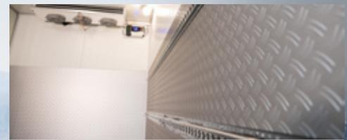
**Vorbereitung für Ladungssicherung.** mit beidseitig 2 Reihen Lochschienen, Transporthalterung für Sperrstangen unter der Innendecke.
