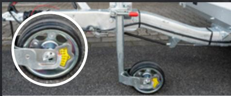
**AL-KO Profi Premium Stützrad.** mit integrierter Radlastwaage, die zulässige Stützlast immer fest im Blick.
