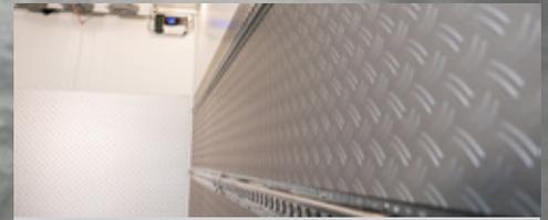
**Vorbereitung für Ladungssicherung.** mit beidseitig 2 Reihen Lochschielen, Transporthalterung für Sperrstangen unter der Innendecke.
