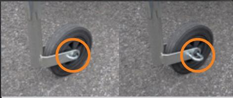
**Stützrad mit PinStop Funktion.** Komfortable Abstellhilfe zur kurzfristigen Positionierung des Anhängers beim Be- und Entladen
