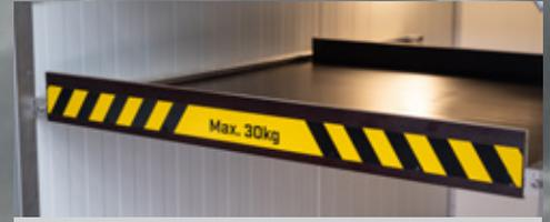
**Zwischenboden.** verschieb- und entnehmbar, ca. LxB 965x995mm, max. 30kg Traglast, Ablage aus Siebdruckplatte, Fixierung mittels Kugelschnäppern und Aluminiumwandführung.
